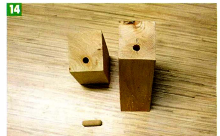
14 Отверстия под шканты делал ближе к внутренней стороне элементов колеса. После скругления наружного периметра восьмигранника они окажутся в центре.
