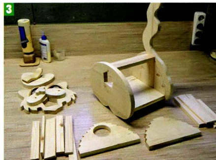
3 Глубина домика (она составляет 20 см) определяется длиной основания и верхней перемычки.
