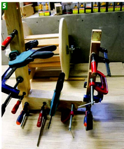
5 При склеивании кронштейна в дело пошли все имеющиеся струбцины.
